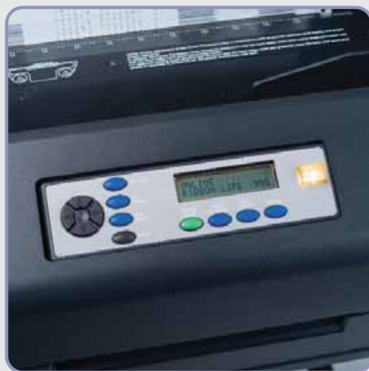
Impostazione dei lavori di stampa con la durata precisa del nastro indicata sul pannello
